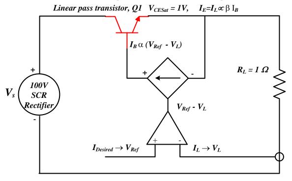
$$\begin{split} V_S &= 100V & I_L = 0 \rightarrow 99A & V_{Q1} = V_S - V_L \\ I_S &= I_L & V_L = I_L * R_L & P_{Q1} = V_{Q1} * I_{Q1} \\ P_S &= V_S * I_S & P_L = V_L * I_L & \textit{Eff} = \frac{P_L}{P_S} \end{split}$$
