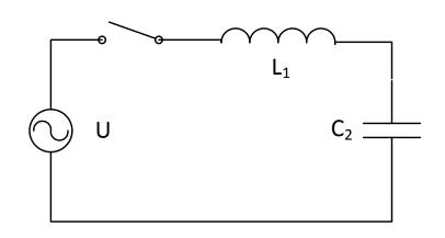
$$\begin{pmatrix} \dot{i_1} \\ \dot{v_2} \end{pmatrix} = \begin{pmatrix} 0 & -1/L_1 \\ 1/C_2 & 0 \end{pmatrix} \begin{pmatrix} i_1 \\ v_2 \end{pmatrix} + \begin{pmatrix} 1/L_1 \\ 0 \end{pmatrix} u$$
