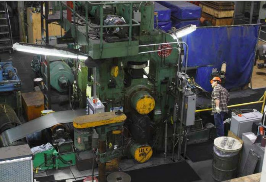
700 mm wide cold rolling mill (Wah Chang)
